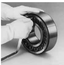
Рис. 1: Замер зазора подшипника на верстаке.
