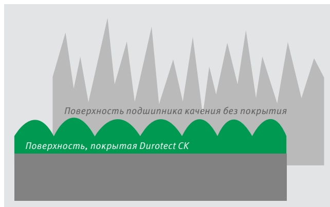
Структурный вопрос: покрытые Durotect SK поверхности более износостойкие и демонстрируют пониженное трение
