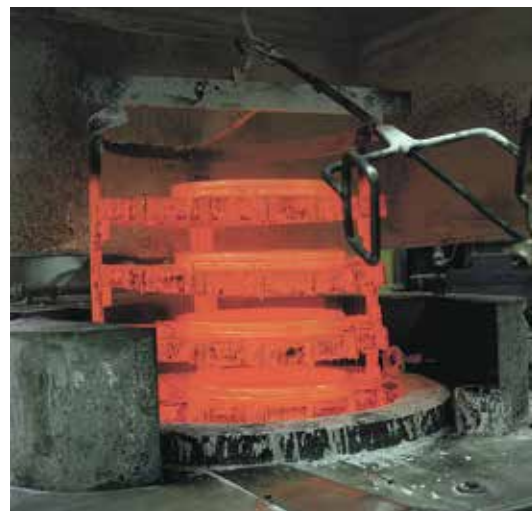
Повышение износостойкости и предела усталостной прочности с помощью цементирования
