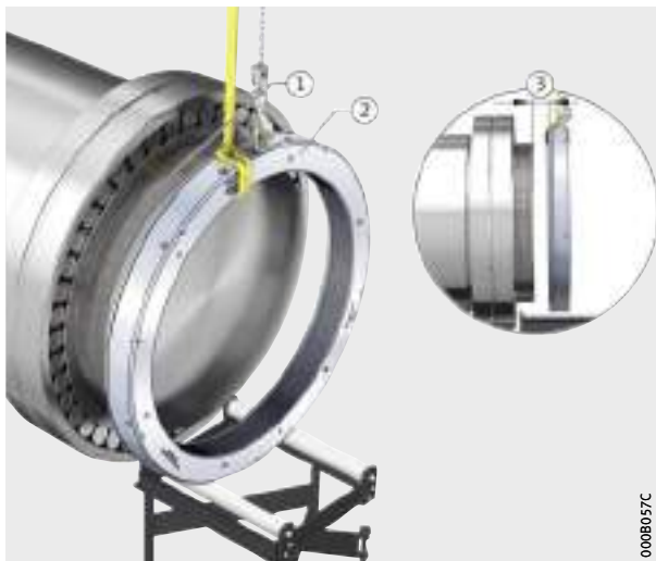
Рисунок 17 Опускание гидравлической гайки
