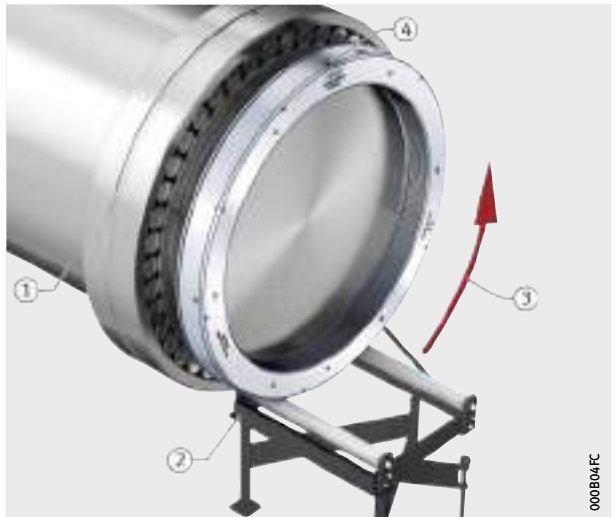
Рисунок 35 Откручивание гидравлической гайки
