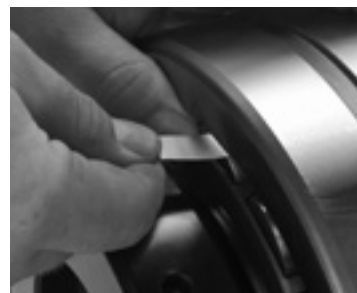
Рис. 18. Измерьте РВЗ до монтажа.
