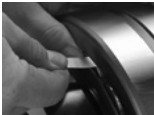
Рис. 14. Измерьте РВЗ до монтажа.
