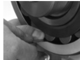
Рис. 15. В процессе монтажа производится проверка РВЗ под ненагруженным роликом.
